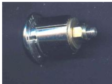
Установка в корпус штатной личинки
